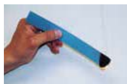
▲サンタックIBシートに着火した状況
